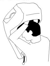
4 PULL DOWN THE LANYARD TO ACTIVATE THE AIR REGENERATION SYSTEM.
